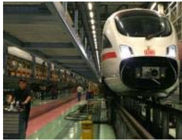
Suche nach Rissen: Alle ICE-T-Züge der Bahn müssen überprüft werden.
